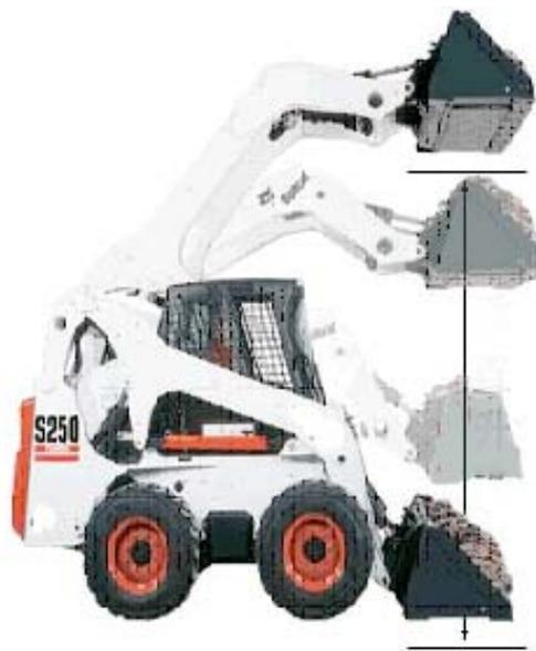
Delta Power 公司成功解决了上述问题。经过近十年的持续改进和各种性能试验,已成功开发了双向(上升和下降)自动平衡装置,完全可满足装载机械的使用要求。这种已专利注册的装置为 BDSL 和 BDSL+双向平衡控制系统。这两种系统采用整体式结构,性价比很高,可在流量 115 升/分以下的各种液压移动系统中工作,效果令人非常满意。独特的回路设计和内部元件功能使 BDSL 和 BDSL+系统成为市场上性价比高,维修率低的电液双向自动平衡系统。该系统现已批量生产,应用于很多厂家的机械上,如 CNH, CASE, AGCO, BOBCAT, Fendt 等。
