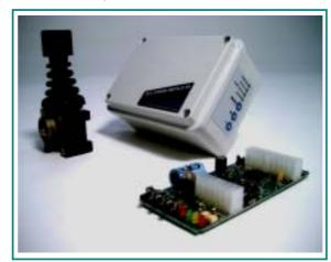
EC-PWM-MPC2脉宽调制电流放大控制器为比例减压阀、流量阀和换向阀设计。输出电流的大小不受比例电磁线圈的印阻及电缆的长短所影响,随比例摇杆的角度及相应输入电压的大小比例而变化,在一定的电压范围内保持正常比例输出叠加于放大电路的震颤信号可以减少阀件之间的摩擦,防止阀件卡死,改善润滑.
